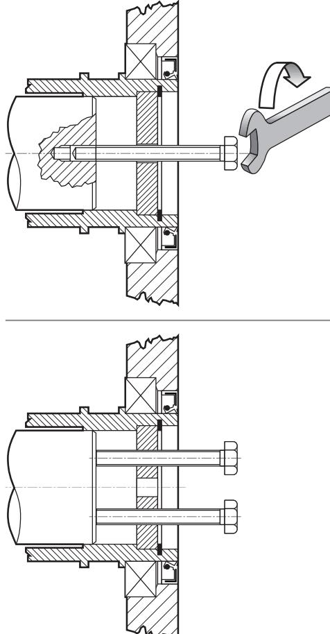
Le superfici di contatto dovranno essere pulite e trattate con adeguati protettivi prima del montaggio, onde scongiurare l'ossidazione e il conseguente bloccaggio delle parti.
